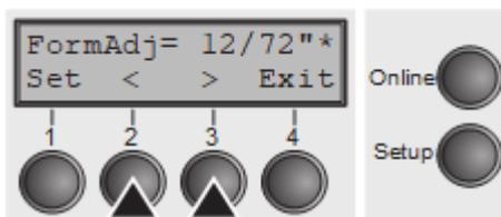
Presione la tecla **<** (2) ó **>** (3) Para mover la primera línea de impresión a la posición deseada. Puede configurar valores de 0 a 220/72 "para papel perforado.
