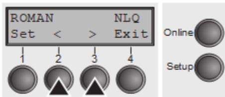
Si presionaste la tecla **Font** (1), usa las teclas **<** (2) o **>** (3) Para seleccionar la fuente deseada. Confirme la selección presionando la tecla **Set** (1).
