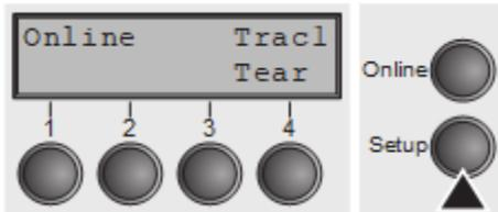
Seleccione el modo de configuración presionando la tecla **Setup**.
