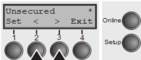
Use < (2) o > (3) para seleccionar la configuración deseada.
