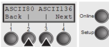
Presione la tecla para el formato ASCII 80 (para papel de 80 columnas) o para ASCII 136 (papel de 136 columnas). La pantalla indicará **Test mode Off**.
